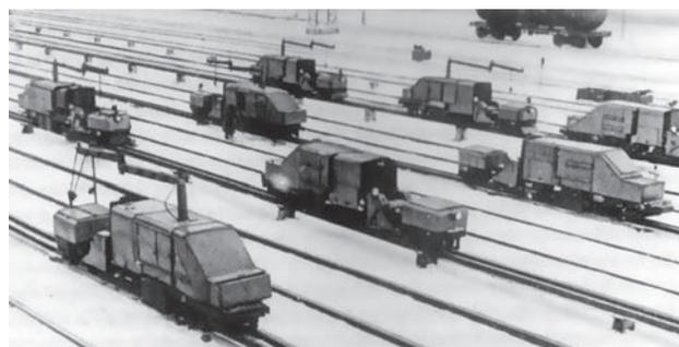
**Вагоноремонтные машины на ПТО станции Барабинск**
