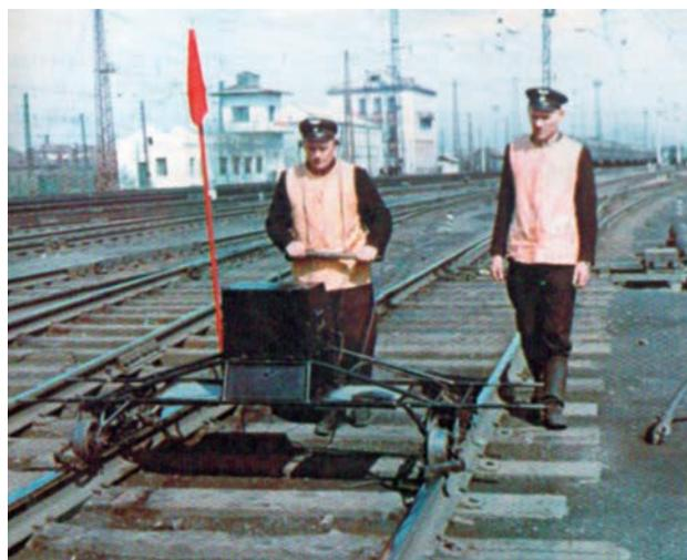
Проверка пути дефектоскопом РДП-56
