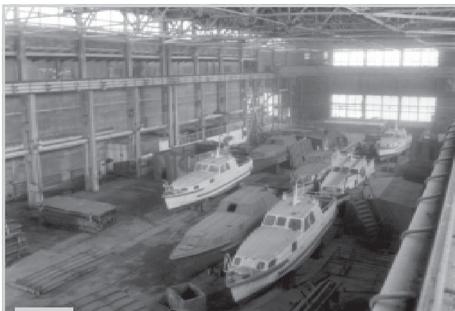
Строительство катеров «ТПК-101» на судовой верфи РЭБ флота
