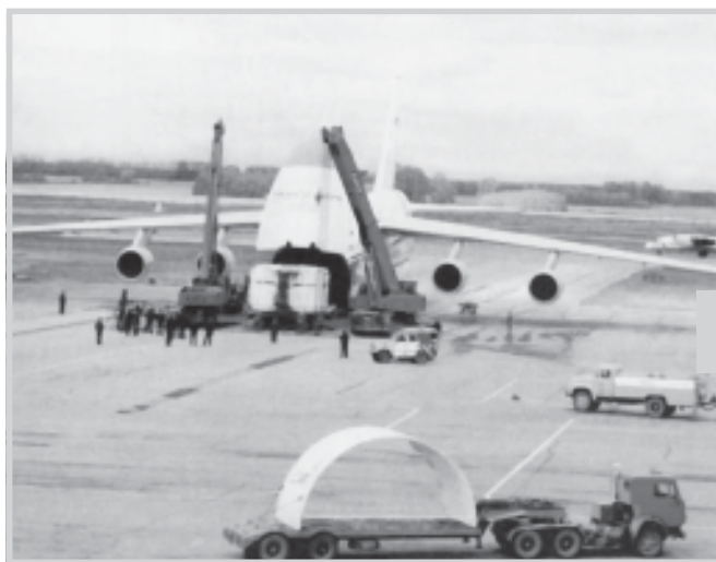
Разгрузка тоннеле- проходческого комплекса «Lovat»
